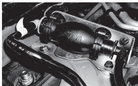
*Sur certains systèmes d'injection le circuit à carburant et dit en pression, le carburant est refoulé par une pompe de gavage électrique, immergé dans le réservoir, et commandé par le calculateur de contrôle moteur via le relais double. La poire d'amorçage dans ce cas n'est pas présente dans le circuit.*
