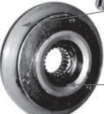
**Baladeur** : permettre l'engrènement du pignon fou avec l'arbre par l'intermédiaire du moyeu.
